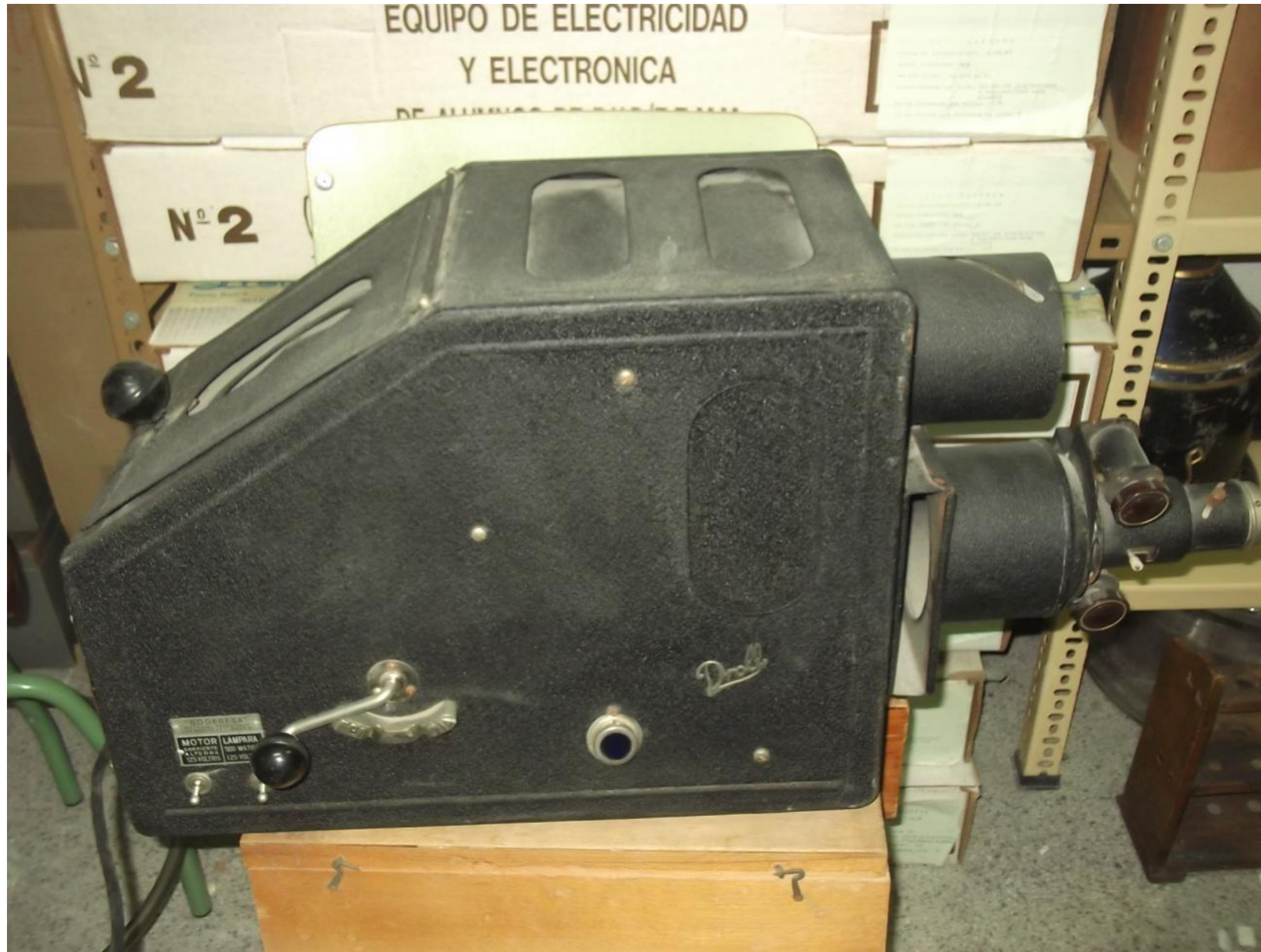
Epidiascopio. Proyector de opacos y diapositivas de cristal. Principios del siglo XX
