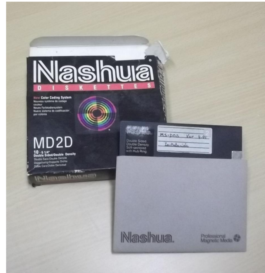
Discos flexibles de 5 ¼, Capacidad de almacenamiento 360 Kb. Hacia 1980
