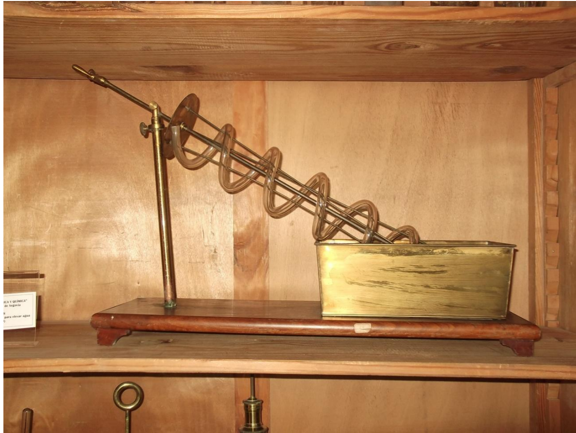
Tornillo de Arquímedes. Hacia 1880
