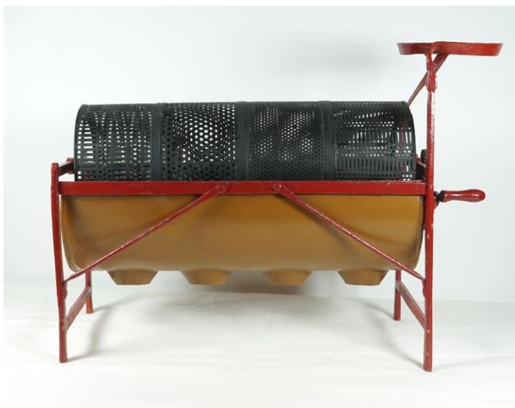
Criba mecánica. Dimensiones: 46 x 17 x 31,5 cm
